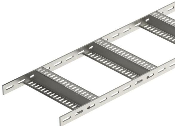
Schiffskabelleiter mit gelochtem Seitenholm in der Seitenhöhe 40 mm mit eingeschweißten, gelochten Z-Sprossen. Belastung geprüft nach IEC in Kombination mit Verbinder Typ SLV.
