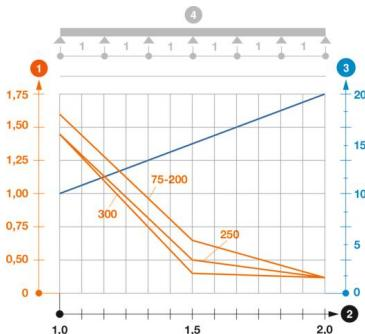
**Belastungsdiagramm Kabelleiter Typ SL42**
