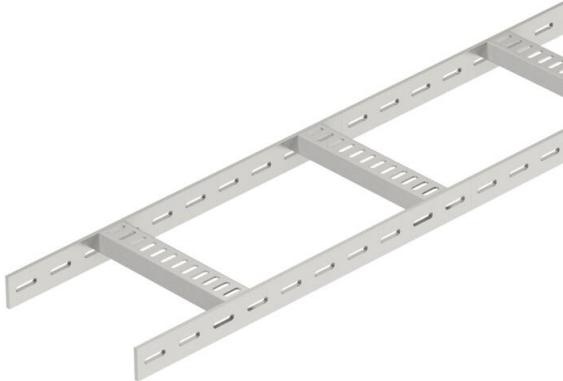
Schiffbau-Kabelleiter mit gelochtem Seitenholm in der Seitenhöhe 40 mm, mit eingeschweißten, nach unten offenen und gelochten Trapezsprossen. Belastung geprüft nach IEC in Kombination mit Verbinder Typ SLV.
