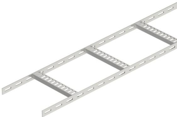
Schiffbau-Kabelleiter mit gelochtem Seitenholm in der Seitenhöhe 25 mm, mit eingeschweißten, nach unten offenen und gelochten Trapezsprossen. Belastung geprüft nach IEC in Kombination mit Verbinder Typ SLV.
