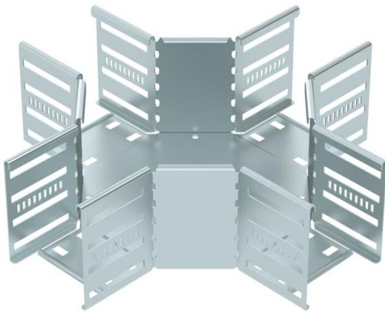
Kreuzung zum Erstellen einer horizontalen Abzweigung, Formteil für rast- und schraubbare Kabelrinnen Seitenhöhe 110 mm. Schraubenlose Montage mit Doppelklemmen oder Schraubverbindung mit Flachrundschrauben FRS und Kombimuttern M6. Einsetzbar im Innenbereich. Befestigungsmaterial muss separat bestellt werden.
