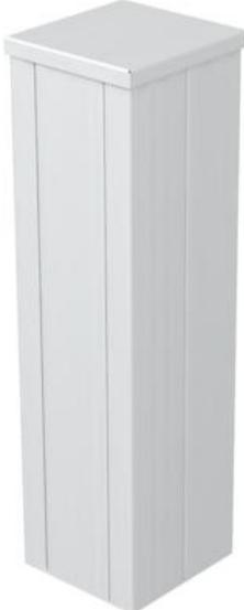
ISS Installationssäule 2-zügig aus Aluminium mit 76,5-mm-Systemöffnung. Leer, bestückbar mit handelsüblichen Geräten (Steckdose, Telefon, usw.), max. 8 Geräte. Befestigung direkt auf dem Fußboden möglich. Geräteeinbaudosen sind separat zu bestellen. Die Installationssäule ist zur Aufnahme von fronestartenden Geräteeinbaudosen der Serie 71GD... geeignet. Optional ist der Einbau einer Trennwand Typ GA-TW (6279711) sowie die Montage der Oberteilklammer Typ KL80A möglich.
