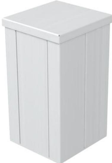
ISS Installationssäule 2-zügig aus Aluminium mit 76,5-mm-Systemöffnung. Leer, bestückbar mit handelsüblichen Geräten (Steckdose, Telefon, usw.), max. 4 Geräte. Befestigung direkt auf dem Fußboden möglich. Geräteeinbaudosen sind separat zu bestellen. Die Installationssäule ist zur Aufnahme von fronestartenden Geräteeinbaudosen der Serie 71GD... geeignet. Optional ist der Einbau einer Trennwand Typ GA-TW (6279711) sowie die Montage der Oberteilklammer Typ KL80A möglich.
