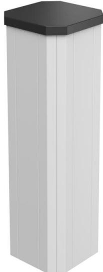
ISS Installationssäule aus Stahlblech mit einer 76,5-mm-Systemöffnung an 4 Seiten. Leer, bestückbar von allen 4 Seiten mit je 6 handelsüblichen Geräten (Steckdose, Telefon, usw.), max. 24 Geräte. Befestigung direkt auf dem Fußboden. Geräteeinbaudosen sind separat zu bestellen. Die Installationssäule ist zur Aufnahme von fronthastenden Geräteeinbaudosen der Serie 71GD... geeignet.
