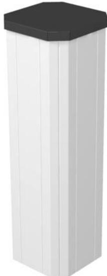
ISS Installationssäule aus Stahlblech mit einer 76,5-mm-Systemöffnung an 4 Seiten. Leer, bestückbar von allen 4 Seiten mit je 6 handelsüblichen Geräten (Steckdose, Telefon, usw.), max. 24 Geräte. Befestigung direkt auf dem Fußboden. Geräteeinbaudosen sind separat zu bestellen. Die Installationssäule ist zur Aufnahme von fronthaltenden Geräteeinbaudosen der Serie 71GD... geeignet.
