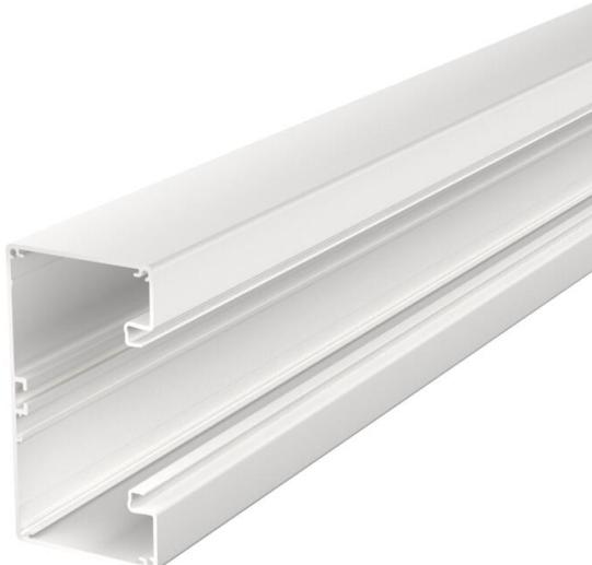
Geräteeinbaukanal ohne Bodenlochung zur direkten Wandmontage oder an Konsolen geeignet. Überlängen bis 6000 mm von Kanalunterteilen und -oberteilen sowie andere RAL-Farben können auf Anfrage realisiert werden. Die Sichtflächen der Geräteeinbaukanäle sind foliert. Das Oberteil muss separat bestellt werden. Wir empfehlen den Einsatz der Kanalklammer.
