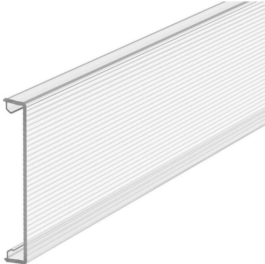
Kanaloberteil zum Verschließen der Geräteeinbaukanäle Rapid 80 GK (PVC), GS (Stahl), GA (Aluminium) und ISS Installationssäulen mit 76,5 mm Systemöffnung. Das Oberteil GK-OTKKP1 ist aus einem klaren, durchsichtigen PC-Material hergestellt und an der Innenseite kanelliert (Längsriefen) und eignet sich somit zur Integration von Beleuchtung in den Kanälen bzw. Säulen.
