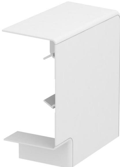
Flachwinkel-Haubenformteil aus halogenfreiem PC/ABS zur einfachen Erstellung einer steigenden oder fallenden 90°-Richtungsänderung mit Geräteeinbaukanal der Serie Rapid 80 GK, GKH, GS und GA. Das Flachwinkel-Haubenformteil ist einsetzbar für symmetrische und asymmetrische Kanaltypen.
