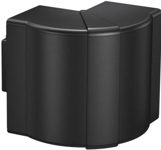
Außeneck-Haubenformteil aus halogenfreiem PC/ABS zur Richtungsänderung von Geräteeinbaukanälen Rapid 80 der Systeme GK, GKH, GS und GA. Die Formteile sind variabel von 80° - 100° verstellbar und einsetzbar für symmetrische und asymmetrische Kanäle.
