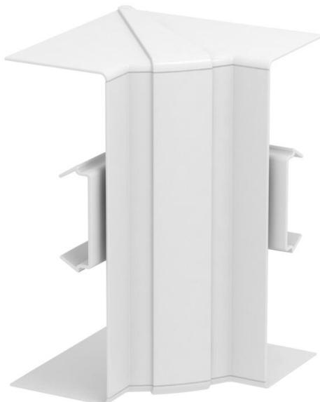
Inneneck-Haubenformteil aus halogenfreiem PC/ABS zur Richtungsänderung von Geräteeinbaukanälen Rapid 80 der Systeme GK, GKH, GS und GA. Die Formteile sind variabel von 85° - 95° verstellbar und einsetzbar für symmetrische und asymmetrische Kanäle.
