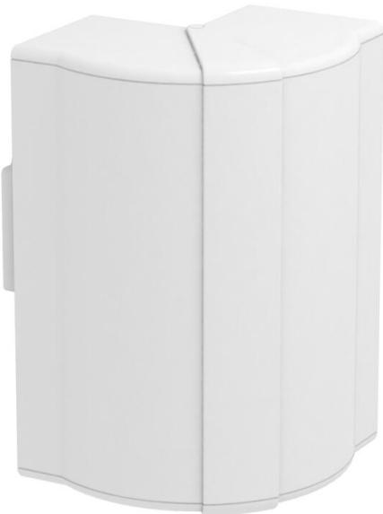
Außeneck-Haubenformteil aus halogenfreiem PC/ABS zur Richtungsänderung von Geräteeinbaukanälen Rapid 80 der Systeme GK, GKH, GS und GA. Die Formteile sind variabel von 80° - 100° verstellbar und einsetzbar für symmetrische und asymmetrische Kanäle.
