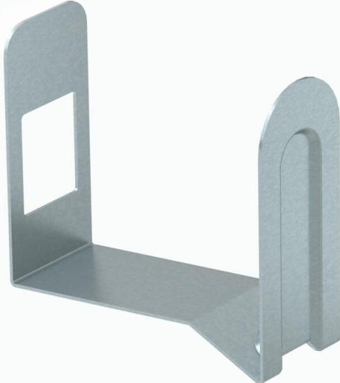
Die Kanalklammer hält die eingelegten Kabel und Leitungen im Kanal und erleichtert somit die Installation an Wand und Decke. Die Kanalklammern werden auf die Schlaufenlochung aufgesteckt und an der Seitenwand eingerastet. Passend für Kanalbreite 80 mm.
