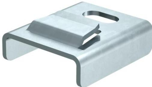
Das Anschlussbauteil ist die Verbindung der Gewindestangensicherung mit dem Abhängesystem für die Verlegearten mit Kabelleitern zum Funktionserhalt nach DIN 4102 Teil 12. Es wird in einem Abstand von maximal 100 mm vom Ausleger auf den Untergurt des Leiterholms gesteckt. Nach Montage der Gewindestange ist das Anschlussbauteil gegen Abrutschen gesichert.
