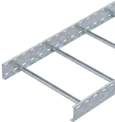
Kabelleiter mit gelochtem Seitenholm in der Seitenhöhe 110 mm mit eingenieteten, nach oben offenen C-Profil-Sprossen.
