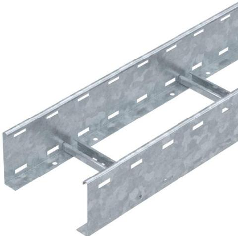
Kabelleiter mit gelochtem Seitenholm in der Seitenhöhe 110 mm mit eingenieteten, nach oben offenen C-Profil-Sprossen.
