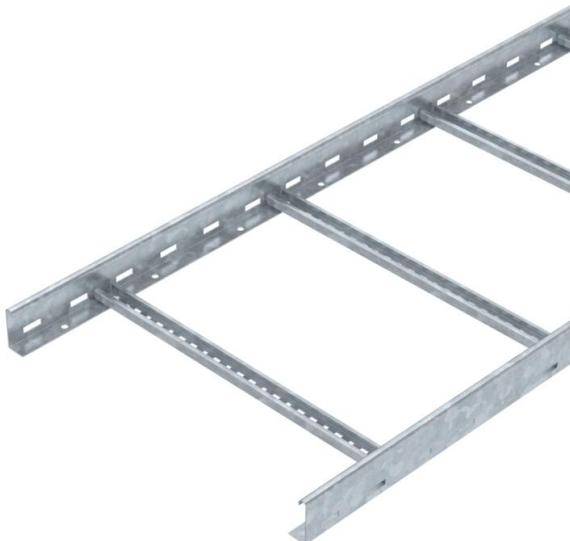
Kabelleiter in Seitenhöhe 60 mm mit eingeschweißten, nach oben offenen C30 Profilsprossen. Eingerollter Seitenholm zur Verstärkung und als Kantenschutz. Die Befestigung auf dem Ausleger erfolgt mit Klemmstücken Typ LKS 40. Das Schlitzmaß der Sprosse beträgt 16,5 mm, die passende Bügelschelle ist der Typ BS-H....
