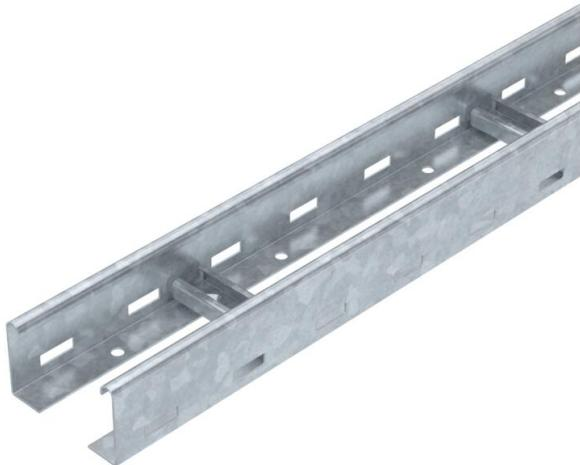
Kabelleiter in Seitenhöhe 60 mm mit eingeschweißten, nach oben offenen C30 Profilsprossen. Eingerollter Seitenholm zur Verstärkung und als Kantenschutz. Die Befestigung auf dem Ausleger erfolgt mit Klemmstücken Typ LKS 40. Das Schlitzmaß der Sprosse beträgt 16,5 mm, die passende Bügelschelle ist der Typ BS-H....
