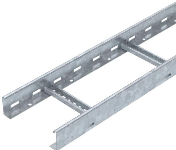
Kabelleiter in Seitenhöhe 60 mm mit eingeschweißten, nach oben offenen C30 Profilsprossen. Eingerollter Seitenholm zur Verstärkung und als Kantenschutz. Die Befestigung auf dem Ausleger erfolgt mit Klemmstücken Typ LKS 40. Das Schlitzmaß der Sprosse beträgt 16,5 mm, die passende Bügelschelle ist der Typ 2056.
