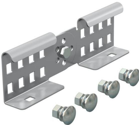
Gelenkverbinder als Außenverbinder zur Verbindung von Kabelleitern und Formteilen mit 60 mm Seitenhöhe und durchgängiger Holmlochung. Winkel vertikal verstellbar.
