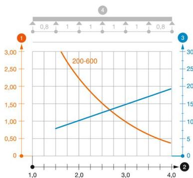
Belastungsdiagramm Kabelleiter Typ LG 60 VS
