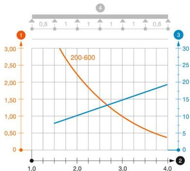
Belastungsdiagramm Kabelleiter Typ LG 60 VS
