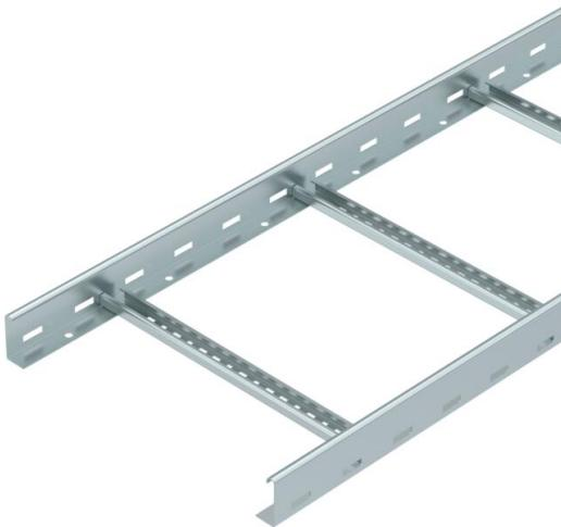
Kabelleiter mit gelochtem Seitenholm in der Seitenhöhe 60 mm mit eingenieteten, nach oben offenen C-Profil-Sprossen (Ausführung VS).
