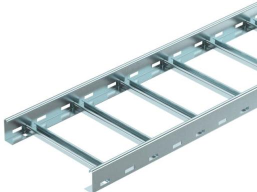
Kabelleiter für die waagerechte Verlegung von Kabeln und Leitungen. Einsetzbar als Normtragekonstruktion für den Funktionserhalt nach DIN 4102 Teil 12. Funktionserhaltklassen E30 bis E90. Mit eingenieteter nach oben offener C-Profil-Sprosse.
