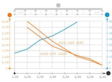
Belastungsdiagramm Kabelleiter Typ SLCS 110
