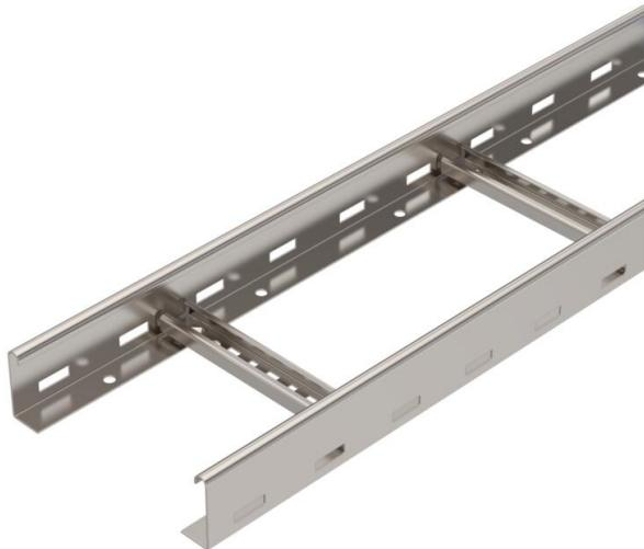
Kabelleiter in Seitenhöhe 60 mm mit eingeschweißten, nach oben offenen C30-Profil Sprossen. Eingerollter Seitenholm zur Verstärkung und als Kantenschutz. Die Befestigung auf dem Ausleger erfolgt mit Klemmstücken Typ LKS 40. Das Schlitzmaß der Sprosse beträgt 16,5 mm, die passende Bügelschelle ist der Typ 2056. Magnetische Schirmdämpfung ohne Deckel 10 dB, mit Deckel 15 dB.
