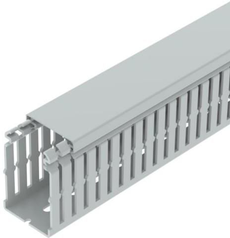
Halogenfreier Verdrahtungskanal nach DIN EN 50085-2-3 inkl. Oberteil und Bodenlochung zur waagerechten und senkrechten Verlegung elektrischer Kabel und Leitungen im Schaltschrank. Ausführung als DIN-Kanal. Das Ausbrechen der Stege erfolgt werkzeuglos. Bodenbündiges Ausführen ist durch Sollbruchstellen möglich. Verjüngungen in den Seitenschlitzen verhindern das Herausfallen der Leitungen. Geprüft nach DIN EN 50085-2-3. Sonderlängen auf Anfrage.
