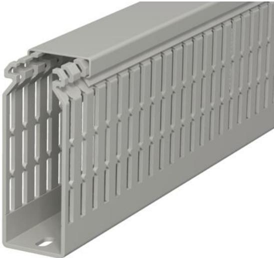
Verdrahtungskanal nach DIN EN 50085-2-3 inkl. Oberteil und Bodenlochung zur waagerechten und senkrechten Verlegung elektrischer Kabel und Leitungen im Schaltschrank. Ausführung als DIN-Kanal. Das Ausbrechen der Stege erfolgt werkzeuglos. Bodenbündiges Ausführen ist durch Sollbruchstellen möglich. Verjüngungen in den Seitenschlitzen verhindern das Herausfallen der Leitungen. Geprüft nach DIN EN 50085-2-3. Sonderlängen auf Anfrage.
