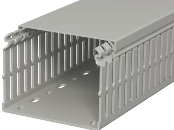
Verdrahtungskanal nach DIN EN 50085-2-3 inkl. Oberteil und Bodenlochung zur waagerechten und senkrechten Verlegung elektrischer Kabel und Leitungen im Schaltschrank. Ausführung als DIN-Kanal. Das Ausbrechen der Stege erfolgt werkzeuglos. Bodenbündiges Ausführen ist durch Sollbruchstellen möglich. Verjüngungen in den Seitenschlitzen verhindern das Herausfallen der Leitungen. Geprüft nach DIN EN 50085-2-3. Sonderlängen auf Anfrage.
