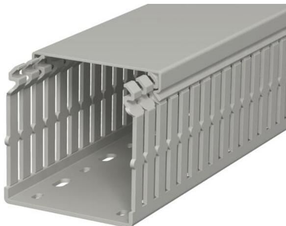
Verdrahtungskanal nach DIN EN 50085-2-3 inkl. Oberteil und Bodenlochung zur waagerechten und senkrechten Verlegung elektrischer Kabel und Leitungen im Schaltschrank. Ausführung als DIN-Kanal. Das Ausbrechen der Stege erfolgt werkzeuglos. Bodenbündiges Ausführen ist durch Sollbruchstellen möglich. Verjüngungen in den Seitenschlitz verhindern das Herausfallen der Leitungen. Geprüft nach DIN EN 50085-2-3. Sonderlängen auf Anfrage.
