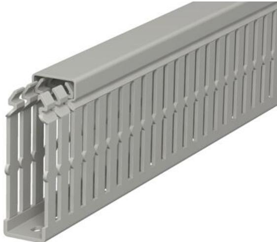
Verdrahtungskanal nach DIN EN 50085-2-3 inkl. Oberteil und Bodenlochung zur waagerechten und senkrechten Verlegung elektrischer Kabel und Leitungen im Schaltschrank. Ausführung als DIN-Kanal. Das Ausbrechen der Stege erfolgt werkzeuglos. Bodenbündiges Ausführen ist durch Sollbruchstellen möglich. Verjüngungen in den Seitenschlitzen verhindern das Herausfallen der Leitungen. Geprüft nach DIN EN 50085-2-3. Sonderlängen auf Anfrage.
