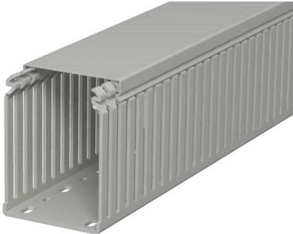
Verdrahtungskanal nach DIN EN 50085-2-3 inkl. Oberteil und Bodenlochung zur waagerechten und senkrechten Verlegung elektrischer Kabel und Leitungen im Schaltschrank. Ausführung als DIN-Kanal. Das Ausbrechen der Stege erfolgt werkzeuglos. Bodenbündiges Ausführen ist durch Sollbruchstellen möglich. Geprüft nach DIN EN 50085-2-3. Sonderlängen auf Anfrage.
