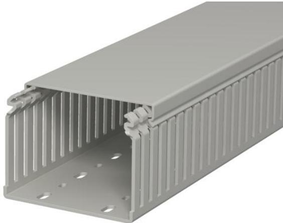
Verdrahtungskanal nach DIN EN 50085-2-3 inkl. Oberteil und Bodenlochung zur waagerechten und senkrechten Verlegung elektrischer Kabel und Leitungen im Schaltschrank. Ausführung als DIN-Kanal. Das Ausbrechen der Stege erfolgt werkzeuglos. Bodenbündiges Ausführen ist durch Sollbruchstellen möglich. Geprüft nach DIN EN 50085-2-3. Sonderlängen auf Anfrage.
