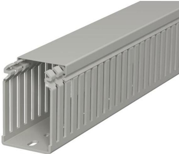
Verdrahtungskanal nach DIN EN 50085-2-3 inkl. Oberteil und Bodenlochung zur waagerechten und senkrechten Verlegung elektrischer Kabel und Leitungen im Schaltschrank. Ausführung als DIN-Kanal. Das Ausbrechen der Stege erfolgt werkzeuglos. Bodenbündiges Ausführen ist durch Sollbruchstellen möglich. Geprüft nach DIN EN 50085-2-3. Sonderlängen auf Anfrage.
