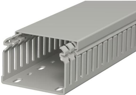
Verdrahtungskanal nach DIN EN 50085-2-3 inkl. Oberteil und Bodenlochung zur waagerechten und senkrechten Verlegung elektrischer Kabel und Leitungen im Schaltschrank. Ausführung als DIN-Kanal. Das Ausbrechen der Stege erfolgt werkzeuglos. Bodenbündiges Ausführen ist durch Sollbruchstellen möglich. Geprüft nach DIN EN 50085-2-3. Sonderlängen auf Anfrage.
