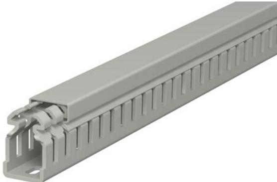
Verdrahtungskanal nach DIN EN 50085-2-3 inkl. Oberteil und Bodenlochung zur waagerechten und senkrechten Verlegung elektrischer Kabel und Leitungen im Schaltschrank. Ausführung als DIN-Kanal. Das Ausbrechen der Stege erfolgt werkzeuglos. Bodenbündiges Ausführen ist durch Sollbruchstellen möglich. Geprüft nach DIN EN 50085-2-3. Sonderlängen auf Anfrage.
