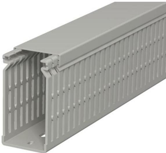
Verdrahtungskanal inkl. Oberteil und Bodenlochung zur waagerechten und senkrechten Verlegung elektrischer Kabel und Leitungen im Schaltschrank. Ausführung als metrischer Kanal. Das Nennmaß der Systemgröße entspricht dem Innenmaß der Kanäle. Das Ausbrechen der Stege erfolgt werkzeuglos. Bodenbündiges Ausführen ist durch Sollbruchstellen möglich. Verjüngungen in den Seitenschlitzen verhindern das Herausfallen der Leitungen. Geprüft nach DIN EN 50085-2-3. Sonderlängen auf Anfrage.
