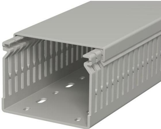
Verdrahtungskanal inkl. Oberteil und Bodenlochung zur waagerechten und senkrechten Verlegung elektrischer Kabel und Leitungen im Schaltschrank. Ausführung als metrischer Kanal. Das Nennmaß der Systemgröße entspricht dem Innenmaß der Kanäle. Das Ausbrechen der Stege erfolgt werkzeuglos. Bodenbündiges Ausführen ist durch Sollbruchstellen möglich. Verjüngungen in den Seitenschlitzen verhindern das Herausfallen der Leitungen. Geprüft nach DIN EN 50085-2-3. Sonderlängen auf Anfrage.
