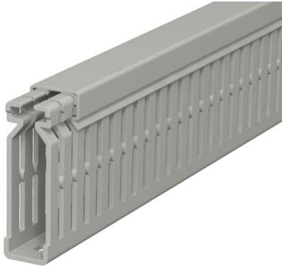
Verdrahtungskanal inkl. Oberteil und Bodenlochung zur waagerechten und senkrechten Verlegung elektrischer Kabel und Leitungen im Schaltschrank. Ausführung als metrischer Kanal. Das Nennmaß der Systemgröße entspricht dem Innenmaß der Kanäle. Das Ausbrechen der Stege erfolgt werkzeuglos. Bodenbündiges Ausführen ist durch Sollbruchstellen möglich. Verjüngungen in den Seitenschlitzen verhindern das Herausfallen der Leitungen. Geprüft nach DIN EN 50085-2-3. Sonderlängen auf Anfrage.
