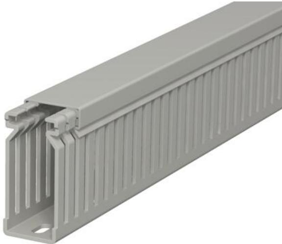
Verdrahtungskanal inkl. Oberteil und Bodenlochung zur waagerechten und senkrechten Verlegung elektrischer Kabel und Leitungen im Schaltschrank. Ausführung als metrischer Kanal. Das Nennmaß der Systemgröße entspricht dem Innenmaß der Kanäle. Das Ausbrechen der Stege erfolgt werkzeuglos. Bodenbündiges Ausführen ist durch Sollbruchstellen möglich. Geprüft nach DIN EN 50085-2-3. Sonderlängen auf Anfrage.
