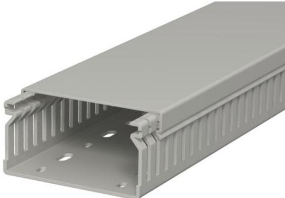
Verdrahtungskanal inkl. Oberteil und Bodenlochung zur waagerechten und senkrechten Verlegung elektrischer Kabel und Leitungen im Schaltschrank. Ausführung als metrischer Kanal. Das Nennmaß der Systemgröße entspricht dem Innenmaß der Kanäle. Das Ausbrechen der Stege erfolgt werkzeuglos. Bodenbündiges Ausführen ist durch Sollbruchstellen möglich. Geprüft nach DIN EN 50085-2-3. Sonderlängen auf Anfrage.
