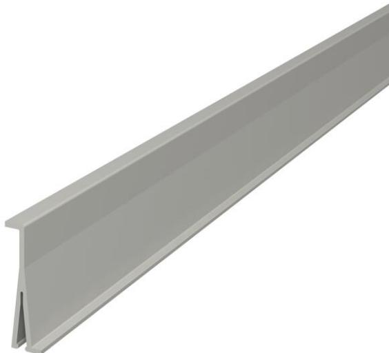
Trennwand zur Unterteilung der WDKH-Kanäle der Kanalhöhe 60 mm zur Installation unterschiedlicher Spannungsebenen.
