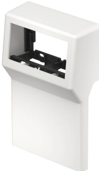
Geräteträger leer für die Sockelleistenkanal-Systeme SL, SL-L und SL-T zur Installation von Einbaueräten in Modul 45-Bauweise für die Kanalbreite 110 mm. Beim Einsatz von Datenmodulen kann aufgrund der Bauform, die Einhaltung des vorgeschriebenen Biegeradius der Datenleitung ggf. nicht gewährleistet werden.
