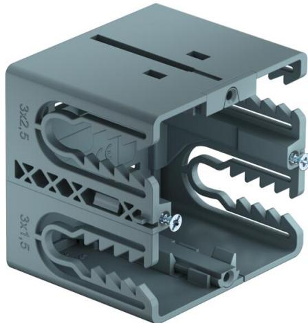
Geräteeinbaudose Signa 1-fach zum Anschluss von Strom- und Datentechnik in den Kanalsystemen Signa Base/Signa Style. Leichter Umbau zur Datendose. Werkzeuglose Montage durch einen Befestigungsriegel und zeitsparender Leitungsanschluss.
