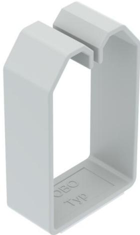
Kabelhalteklammer für LKV-Verdrahtungskanäle. Die Kabelhalteklammer umfasst alle im Kanal installierten Leitungen und verhindert das Herausfallen beim Abnehmen der Oberteile. Mit Klebeband an der Unterseite zur Montage.
