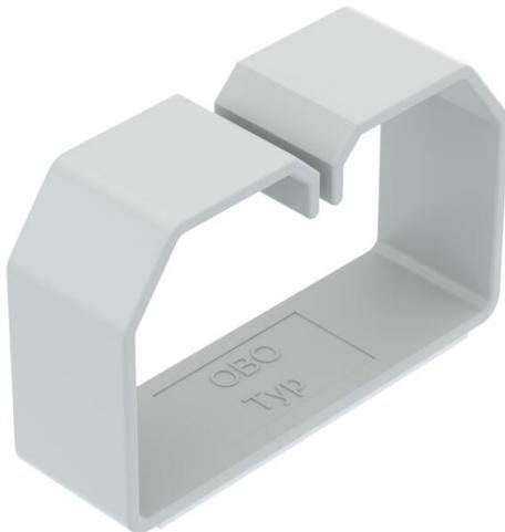
Kabelhalteklammer für LKV-Verdrahtungskanäle. Die Kabelhalteklammer umfasst alle im Kanal installierten Leitungen und verhindert das Herausfallen beim Abnehmen der Oberteile. Mit Klebeband an der Unterseite zur Montage.
