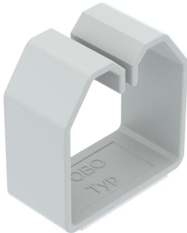
Kabelhalteklammer für LKV-Verdrahtungskanäle. Die Kabelhalteklammer umfasst alle im Kanal installierten Leitungen und verhindert das Herausfallen beim Abnehmen der Oberteile. Mit Klebeband an der Unterseite zur Montage.
